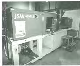
成形機（日本製鋼所J85EL II、他6台）
