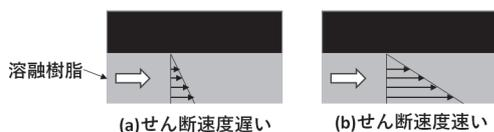
図1 せん断速度の概念図
